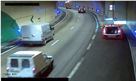
Détection véhicule arrêté
